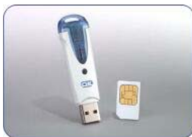
Figura 4: Exemplo de smart card e leitor USB dongle (OMNIKEY CardMan)
